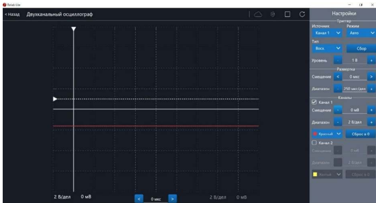
Рис. 40. Сигнал с ненулевым смещением
